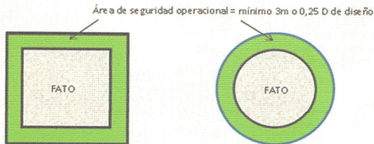
Figura C-1. FATO y área de seguridad operacional conexas.
